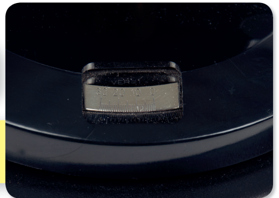
Winkelablesung in zwei Fenstern auf 1 Bogenminute genau
