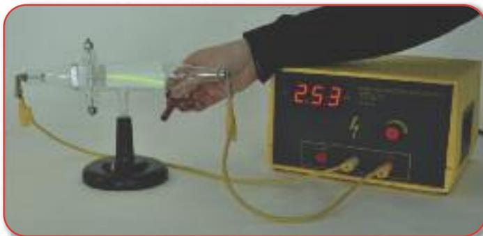
**Versuch:** Elektronenstrahlableitung durch einen Magneten
