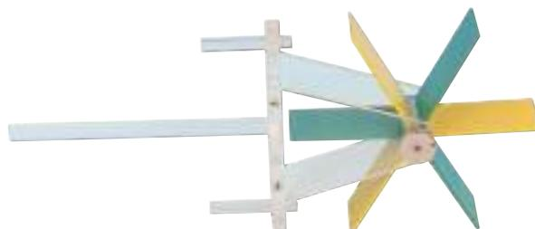
Acrylglasmodell auf Stiel D=10 mm, L=145 mm; zwei Schlauchstutzen (D=8 mm) zur Verwendung als ober- und unterschlächtiges Wasserrad; 6 Antriebsplatten aus Kunststoff, farbig lackiert (je 70x40 mm) mit seitlicher Schnurscheibe; Wasserrad-D=138 mm; Abmessungen gesamt: ca. 290x140x65 mm
