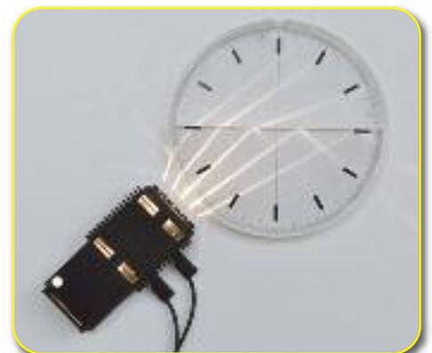
Versuch: Brechungserscheinungen von Lichtstrahlen beim Übergang von Wasser in Luft und verschiedenen Winkeln
