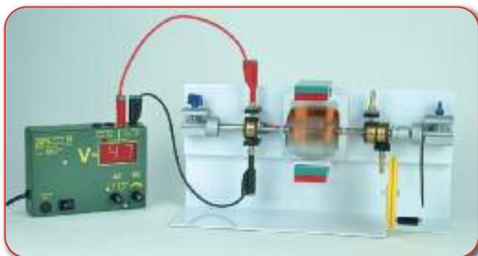
Versuch: Elektromotor mit Zweipolrotor
