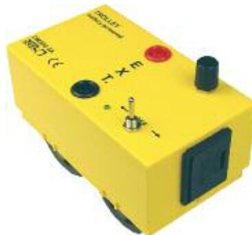
Batteriebetrieben; für Experimente zur gleichförmigen Bewegung; Potentiometer zur stufenlosen Verstellbarkeit der Geschwindigkeit; Wahlschalter: Vor/Aus/Zurück; Buchsen zur externen Spannungsversorgung (ungleichförmige Bewegung); Batterie (9V) ohne Öffnen des Gehäuses wechselbar; Abmessungen: ca. 124x69x85 mm
