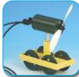
**Versuch:** Durch Motor mit Propeller erzeugter Rückstoß
