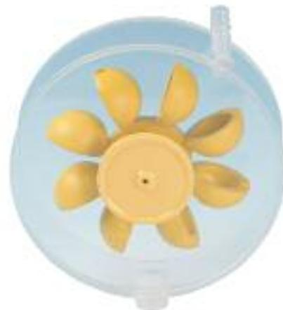
Freistrahlturbinenmodell eingebaut in Acrylglasbehälter; mit der Turbine fest gekoppelte Antriebswelle mit Schnurrolle; Einlassstutzen 1/2" für Wasserschlauch C7445-1K sowie bodenseitiger Entleerungsstutzen 1"; mit Befestigungsstiel: 10x30 mm; D = 200 mm
