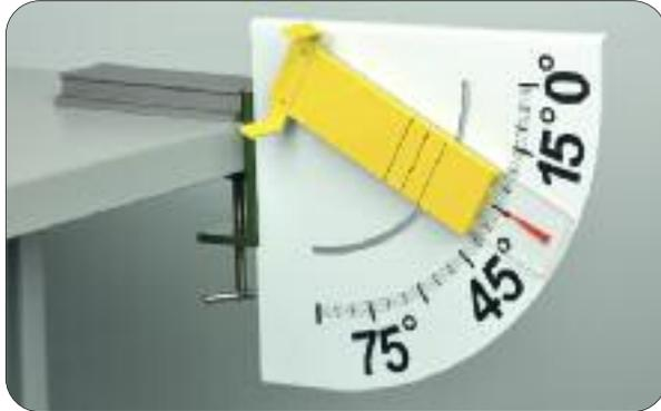
Zur Demonstration des Schiefen Wurfes mit festen Körpern oder Flüssigkeiten; Große Skala aus Metall mit rasch ver- und feststellbarem, breiten Zeiger in Signalfarbe, daher auch aus weiter Entfernung gut sichtbar; fix montierte Tischklemme sowie Fußwangenprofil zur Befestigung an Tischen bis zu einer Stärke von 48 mm; Metallbügel zur Auflage einer Wurfkugel; Ziffernhöhe der Skala: 26 mm; Abmessungen: 260x210x35 mm
