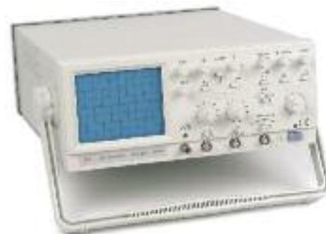
Für Messungen in Demonstrations- und Schülerversuchen; Bildschirmgröße: 80x100 mm, mit Messraster; X-Ablenkung: 0,2 s ... 20 ns/DIV, mit Feinregler; Y-Ablenkung: 1mV ... 5 V/DIV, mit Feinregler; Triggerung: auto, norm, TV-H, TV-V; Betriebsarten: Ch1, Ch2, Ch1+Ch2, Ch1-Ch2, XY-Darstellung; Eingangsimpedanz: 1 MOhm/30 pF, Kopplung: DC, AC, GND; Max. Eingangsspannung: 400 V AC/DC; Anschlussspannung: 230 V AC/50...60 Hz; Abmessungen: ca. 316x132x410 mm, Masse: ca. 7,8 kg
