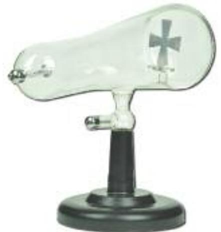
Zum Nachweis der geradlinigen Ausbreitung von Elektronenstrahlen; Vakuum-Glasrohr mit Elektroden und außenliegenden Metallkappen; Metallkreuz; mit Kunststofffuß; Glasrohr: L=ca. 230 mm, D=ca. 80 mm
