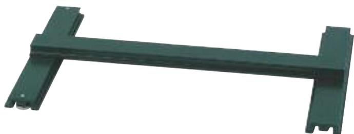
Standfester Universal-Stativfuß; Alu-Sonderprofil; grün pulverbeschichtet; fix verschraubt mit 2 Nivellierschrauben; Gummifüßchen; stirnseitige Bohrungen zur Befestigungsmöglichkeit auf Tischen mit der Tischklemme Demo; für einen weiteren Aufbau werden Stativreiter benötigt; Standfläche: 500 x 325 mm
