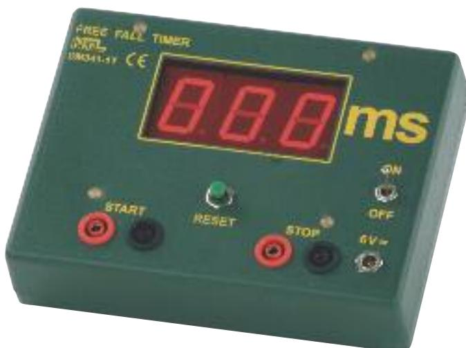
Einfach zu bedienender Zähler, der in Millisekunden die Zeit zwischen Start und Stopp ermittelt; 26-mm-LED-Display; 2 Sicherheitsbuchsen-Paare; Ein/Aus – Schalter, Reset-Taste für einfache Null-Stellung; batteriebetrieben 4x1,5V Mignon-Zellen oder durch Steckernetzgerät 6V/500 mA, P3120-6N (als Zubehör erhältlich); Abmessungen: ca. 160x120x45 mm; Gewicht: ca. 385 g
