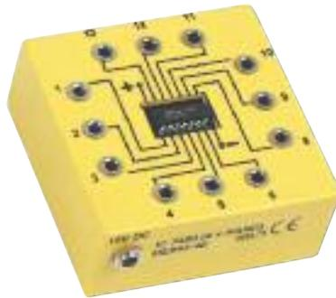
Dieser Baustein soll die Verbindung zwischen den einfachen Logik-Gattern und der industriellen Anwendung in integrierten Schaltkreisen (IC) darstellen.
