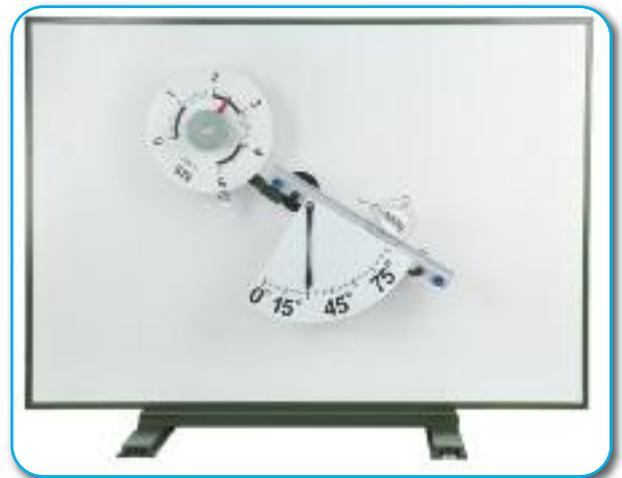
**Versuch:** Geneigte Ebene (Magnetaufbau)
