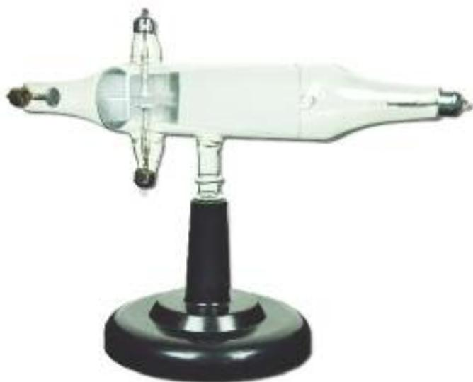
Zur Demonstration der Ablenkung von Elektronenstrahlen im magnetischen Feld; Vakuum-Glasrohr mit Elektroden und außenliegenden Metallkappen; Spaltblende und Leuchtschirm (75 x 35 mm); zwei horizontal angeordnete Elektroden zur Ablenkung des Elektronenstrahls; mit Kunststofffuß; Betriebsspannung: ca. 2–3 kV; Glasrohr: L= ca. 270 mm, D= ca. 40 mm
