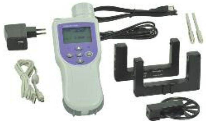
Kompakte, intelligente Zeitmesseinheit; durch die exakte 0,1 ms-Auflösung und eine einfach bedienbare Menüführung mit Speichermöglichkeiten sind Experimente zur Bewegungslehre einfach mess- und berechenbar; mit Gabellichtschranken und –Speichenrad können auch Resultate für Geschwindigkeit und Beschleunigung angezeigt werden;
