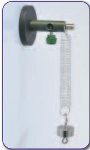
**DS110-43** Magnetfuß 43, mit Säule und Lagerbolzen
