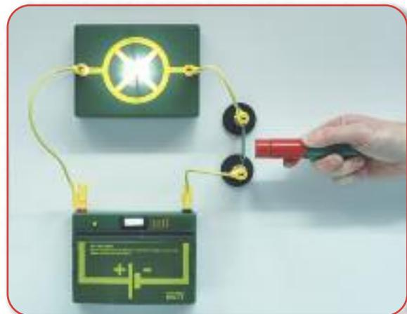
Versuch: Modell eines Reed-Relais-Schließen des
