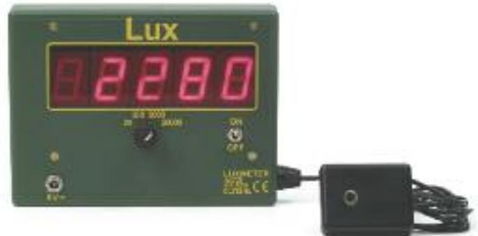
Demonstrations-Messinstrument zur Messung der Lichtstärke in einem weiten Bereich; das Gerät ist sehr handlich und magnethaftend; die 26-mm-große LED-Anzeige für den Messwert erlaubt eine exakte Ablesung auch aus größerer Entfernung
