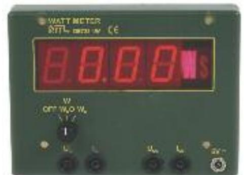
Demonstrations-Messinstrument für Leistungsmessungen in Niederspannungskreisen;
