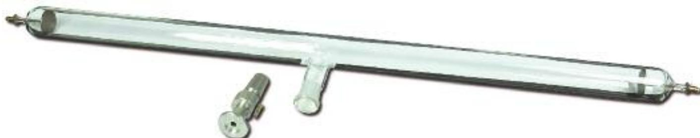
Zur Demonstration der druckabhängigen Leuchterscheinungen bei einer Gasentladung; Dickwandiges Glasrohr mit mittigem Absaugrohr mit NS19/26; an den Enden Scheibenelektroden mit außenliegenden Metallkappen zur Zuführung von Hochspannung; Kupplungsstück aus Metall mit DN 16 Flansch und Belüftungsschraube; Maße: L=700 mm, D=50 mm
