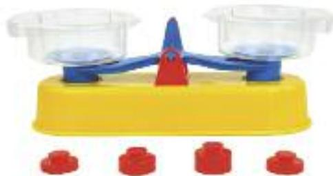
Zur groben Bestimmung der Masse eines festen oder flüssigen Körpers durch den Vergleich mit Standardgewichten; Gleicharmiger Waagebalken aus Kunststoff mit angehängten Tafeln und zwei abnehmbaren, transparenten Schalen; inkl. 4 nicht definierte Gewichte unterschiedlicher Masse; Waagschalen: D=110 mm, Füllvolumen: ca. 300 ml; Wägebereich: ca 250 g, Empfindlichkeit: ca. 0,5 g; Abmessungen: 330x125x125 mm
