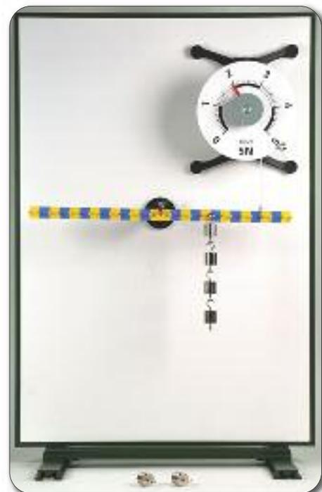
Versuch: Einseitiger Hebel (Magnetaufbau)
