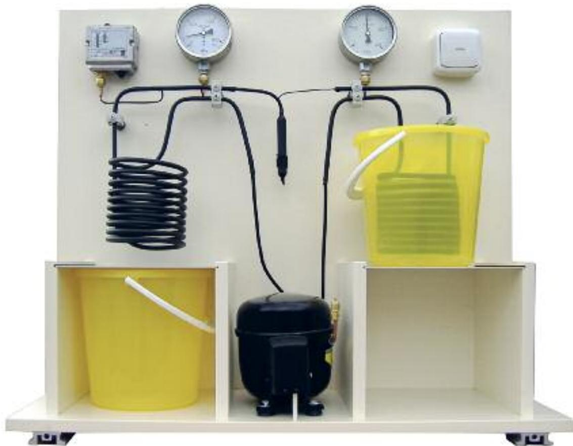
Eine Wärmepumpe ist eine Wärmekraftmaschine. Wird diese als Wärmepumpe genutzt, so liegt ihr Nutzen in der Erwärmung des wärmeren Reservoirs, z.B. eines Wohnraumes. Das kältere Reservoir kann kühles Wasser (Fluss, Grundwasser,..), Erdreich oder Außenluft sein. Wird sie jedoch als Kältschrank genutzt, so liegt ihr Nutzen in der Abkühlung des kälteren Reservoirs, z.B. Kühlfach. Das wärmere Reservoir ist die Umgebungsluft des Kühlgerätes.
