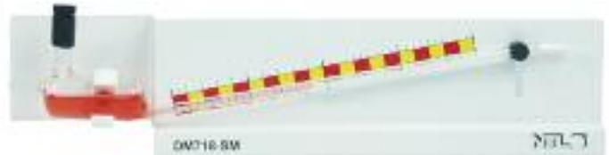
Zur Anzeige von sehr geringen Druckunterschieden; Schrägröhrmanometer aus Glas; Steigungswinkel von Vorratsgefäß und Steigrohr verstellbar; Grundplatte aus Metall; pulverbeschichtet; mit Skala; Druck-Schlauchanschluss-D=5 mm; Steigrohr-L=250 mm; Abmessungen: 385x50x90 mm
