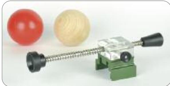
Zur Demonstration des Schiefen Wurfes mit großen Kugeln; Stoßbolzen mit drei Arretierhaken zur Erzeugung unterschiedlicher Abstoßgeschwindigkeiten, mit Spannfeder, leichtgängigem Auslösezylinder sowie Fingergriff zum einfachen Spannen; Fixiermöglichkeit auf dem „Wurfgerät Basis“ sowie NTL-Schienenprofilen;
