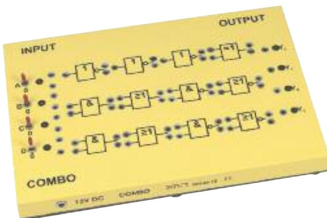
Für 30 Experimente zum Kennenlernen der logischen Grundfunktionen, Kombination von Logikgattern, Schaltungsaufbau von EXOR-Gatter, Regel von De Morgan, Voll- und Halbaddierer, Überprüfen diverser Rechengesetze der Boole'schen Algebra, Kodier- und Dekodierschaltung, RS-Flip-Flop;
