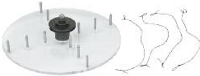
Für Versuche zu den Themen Drehbewegung und Trägheitsmoment; axial kugelgelagerte Acrylglascheibe,  $D = 160$  mm, mit Wellrad, zum Aufsetzen auf den Kräfte-Tisch, jeweils 3 zu  $90^\circ$  angeordnete Metallbolzen im Abstand von 25/50/75 mm zum Zentrum, zur Aufnahme von Schnüren oder Schlitzgewichten;
