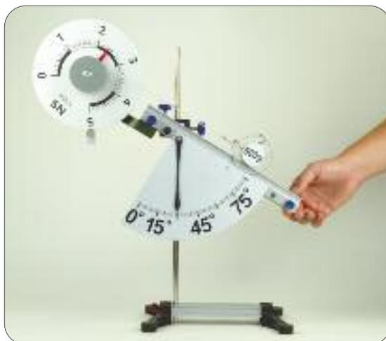
Ein kompletter Demo-Aufbau der geneigten Ebene; inkl. Stativmaterial, Rollkörper und Torsionskraftmesser
