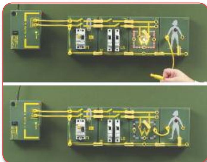
**Versuch:** Berührung des nicht geerdeten stromdurchflossenen Verbrauchers mit Körperschluss – FI-Schutzschalter schaltet sofort ab
