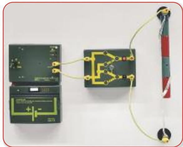
**Versuch:** Kraftwirkung eines stromdurchflossenen Leiters im Magnetfeld – Magnettafelauflauf
