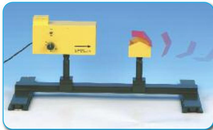
**Versuch:** Abheben eines Hausdaches mit geringer Neigung bei starker Strömung (Sturm)
