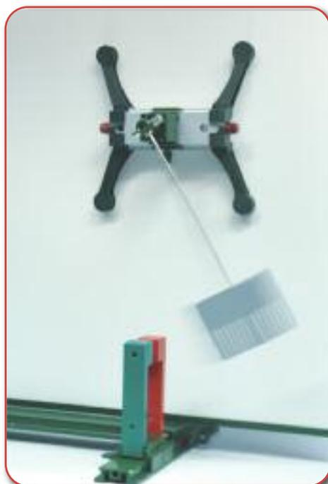
**Versuch:** Waltenhofen'sches Pendel im Magnetfeld des "U-Magneten variabel"
