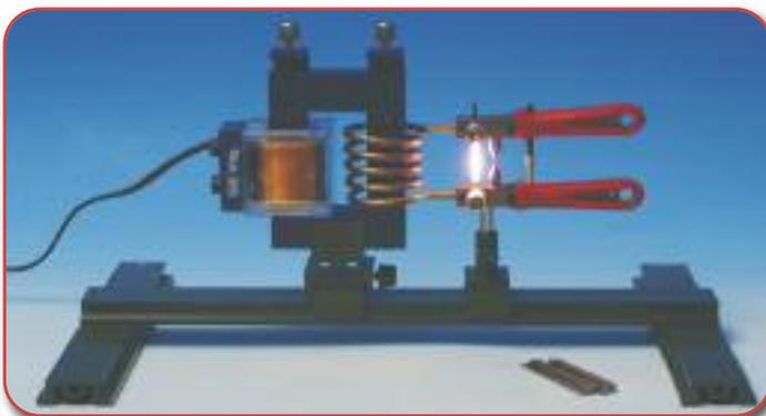
Versuch: Hochstromtrafo – Schmelzen eines Eisennagels
