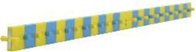
Alu-Vollprofil mit Kunststoffelementen und Noppen zur Halterung von Massen oder Waagschalen; 2 Bohrungen für stabiles oder labiles Gleichgewicht
