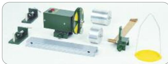
Zur Demonstration des mechanischen Wärmeäquivalentes; starker Antriebsmotor mit Getriebe, Antriebswelle mit Adapter zur Aufnahme der Sechskant-Achse einer Alu-Vollwalze; zwei Vollwalzen aus Aluminium mit erhöhtem Rand zur Auflage und Führung eines Lederbandes, welches im Betrieb eine gleichmäßige Reibung herbeiführt; Walzen jeweils mit Lager- und Antriebsachse;
