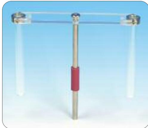
Modell einer Zentrifuge mit Trägerbrücke (220x40 mm) und schwenkbarer Halterung für 2 Probegläser mit  $D_a=16$  mm; auf Stiel  $D=10$  mm, Gesamthöhe: 210 mm
