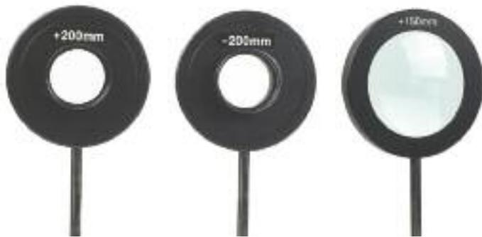
Glaslinsen in schwarzer Kunststofffassung auf Stiel; mit Angabe der Brennweite auf der Fassung; Stiel: L= 90 mm, D= 10 mm; Abstand Linsenmitte-Stielende= 150 mm; Linsen-D= 50 mm, Fassung-D= 120 mm
