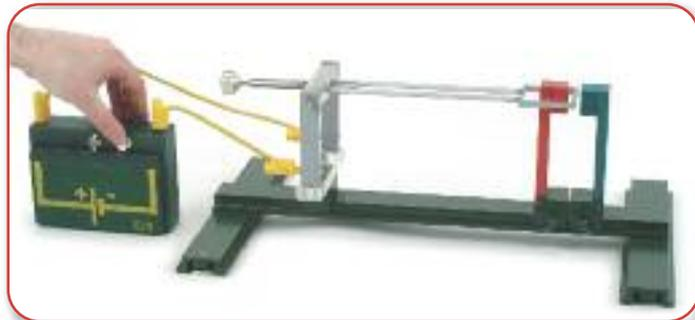
**Versuch:** Kraftwirkung eines stromdurchflossenen Leiters im Magnetfeld
