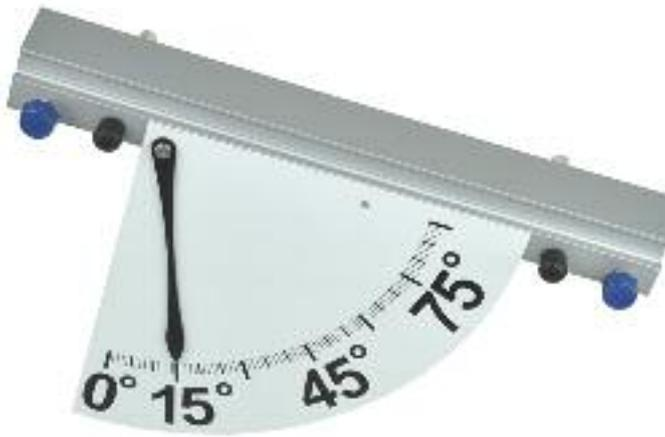
Zur Demonstration der Versuche zur „Geneigten Ebene“; NTL-Schienenprofil, silber beschichtet; zwei Stativstangen zur Befestigung; mit großer Metall-Skala 0 – 90°; Schraube zur Befestigung des Torsionskraftmesserhalters; Schienenlänge: 320 mm; Zeigerlänge der Skala: 130 mm; Ziffernhöhe der Skala: 26 mm
