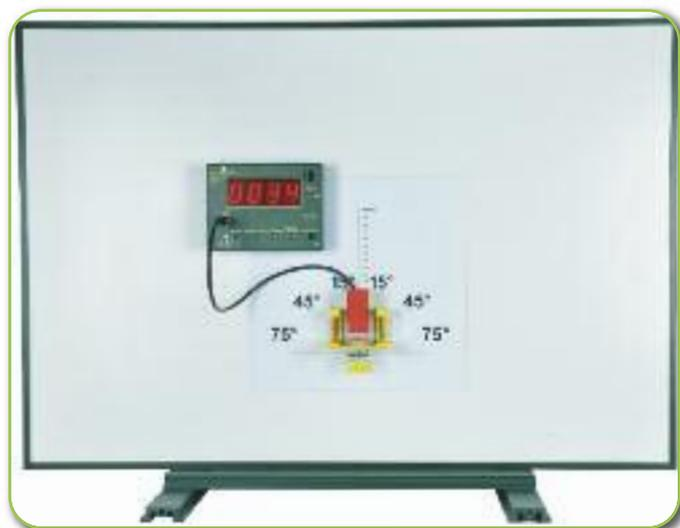
**RAI 3.6** Strahlenbelastung durch externe Bestrahlung von Betastrahlung
