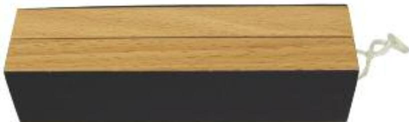
Um die Haft- und Gleitreibung eindeutig aufzuzeigen ist die Verwendung eines Kraftsensoren in Kombination mit einer Messwerterfassung per Computer empfohlen. Am Kraft-Zeit-Diagramm des nachfolgenden Screenshots können die „Spitzen“ der Haftreibung sehr schön abgelesen werden.
