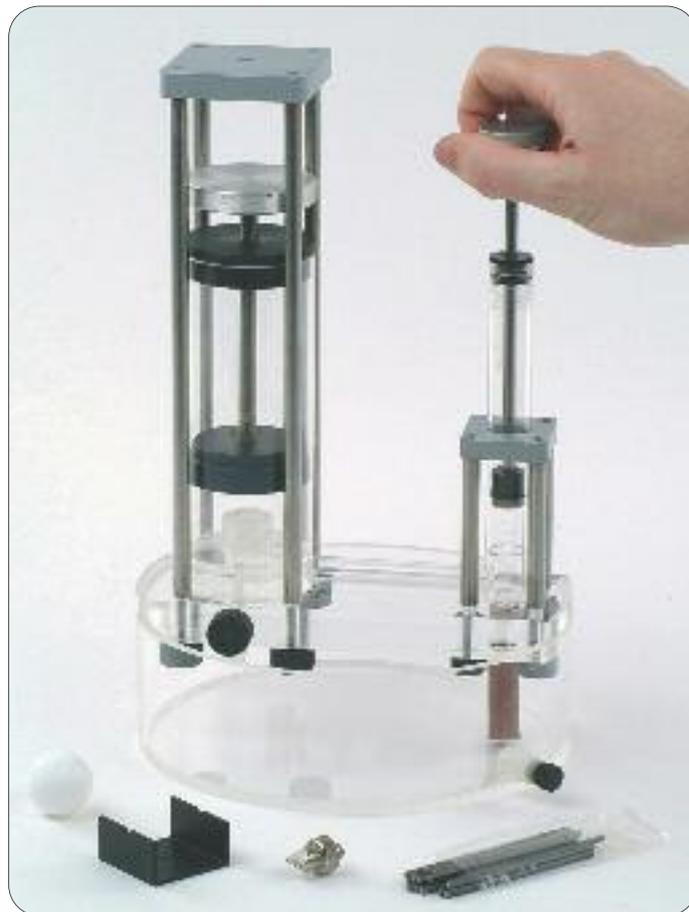
Acrylglasmodell zur Demonstration der hydraulischen Kraftübertragung;
