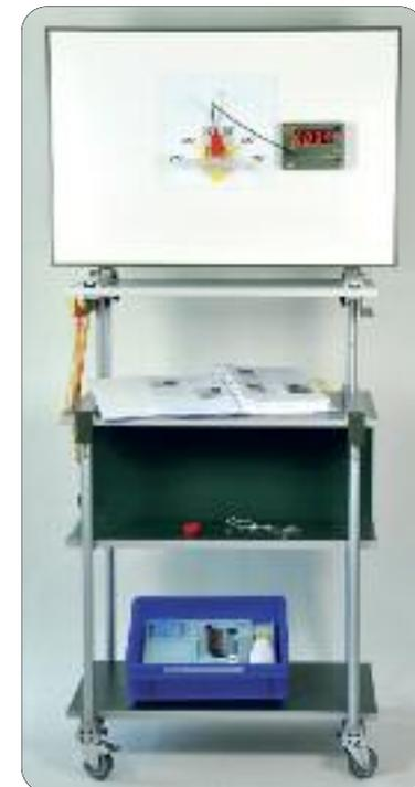
Versuch: Strahlenbelastung durch Betastrahlung (extern)
