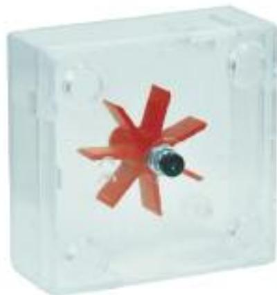
Pelton turbine in transparentem Gehäuse; aufsteckbar auf den MBC Motor/Generator; bodenseitig 4 Zapfen zur Arretierung am MBC Motor/Generator; kleine Einlassöffnung für Wasserhahn oder Luftpumpe; auf der Gegenseite größere Ausflussöffnung
