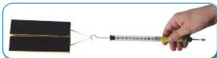
**Detail:** Verdopplung der Oberfläche durch Aufklappen des Klotzes
