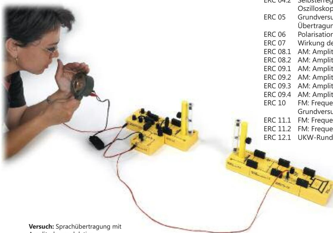
**Versuch:** Sprachübertragung mit Amplitudenmodulation
