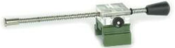
Zur Verwendung als Abstoßvorrichtung mit guter Reproduzierbarkeit bei Dynamik-Experimenten auf der Fahrbahn; Stoßbolzen mit acht nummerierten Arretierrillen zur Erzeugung unterschiedlicher Abstoßgeschwindigkeiten, mit Spannfeder, leichtgängigem Auslösezylinder sowie Fingergriff zum einfachen Spannen; Fixiermöglichkeit auf NTL-Schienenprofilen; Abmessungen: 240x60x50 mm
