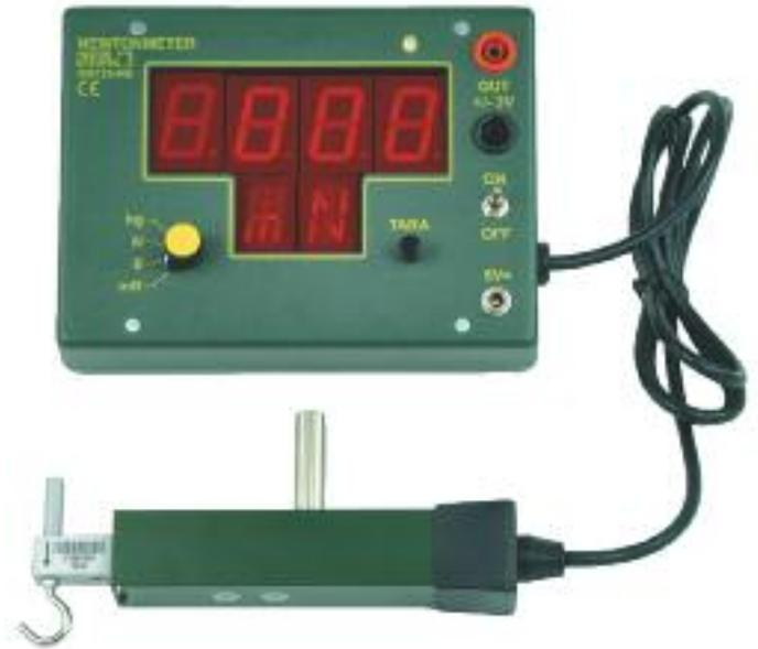
Magnethaftendes Demo-Meßinstrument zur Messung von Kraft (Newton) oder Masse (Gramm).
