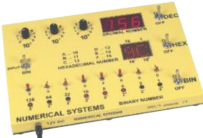
Dieses Panel dient zur Demonstration der in der Informatik verwendeten Zahlensysteme (Dualsystem und Hexadezimalsystem);
