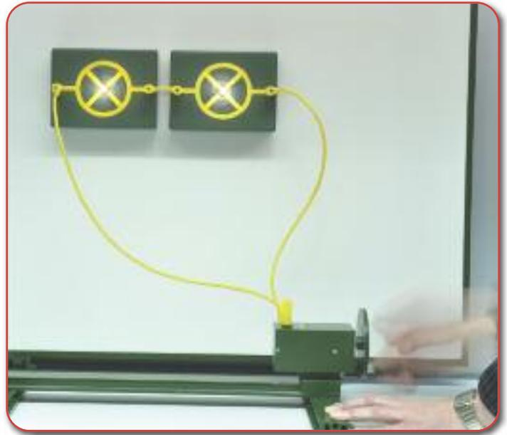
**Versuch:** Generator - Arbeit und Leistung, Reihen- und Parallelschaltung von Glühlampen
