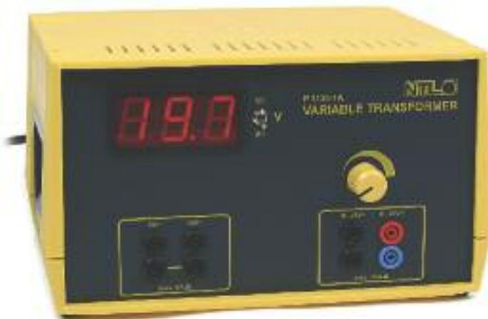
Stromversorgung für Gleich- und Wechselspannungen hoher Belastbarkeit, überlastgeschützt durch thermische Sicherungsautomaten (Überstromschuttschalter)
