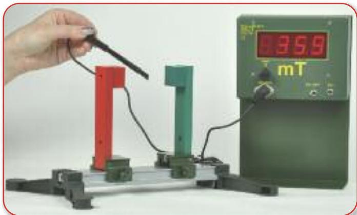
**Anwendung:** Messung der magnetischen Flussdichte im Feld des U-Magneten variabel mit Hilfe des Teslameters DE722-1M
