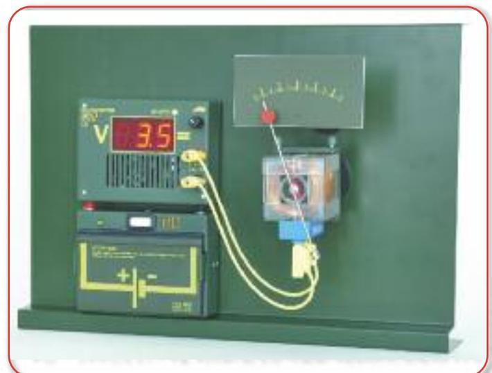
**Versuch:** Modell eines Dreheisenmesswerkes
