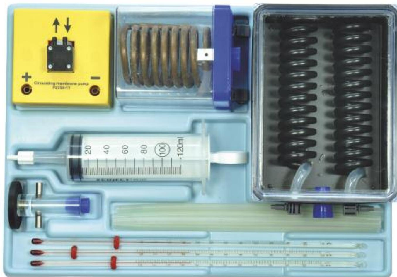
Komplettes Arbeitsmodell einer Solaranlage; der Wasserkreislauf wird sehr übersichtlich dargestellt und ist daher einfach nachvollziehbar; Temperaturmessungen im Kollektor, im Wärmetauscher und im Zirkulationskreislauf
