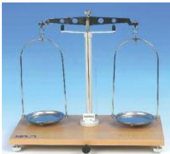
Präzisionswaage mit gehärteter Stahlschneide; 2 abnehmbaren Metallschalen, D=125 mm; Drehknopf zur Arretierung; Grundplatte mit Justierschrauben; Lot zur exakten waagrecht Positionierung; Wägebereich: 500 g; Empfindlichkeit: 0,005 g; Abmessungen: 460x250x410 mm
