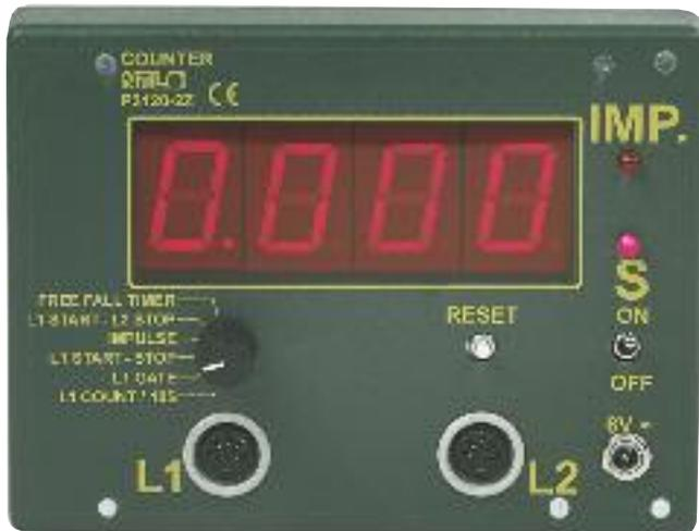
Universell einsetzbarer magnethaftender digitaler Zeitähler; batteriebetrieben; zum direkten Anschluss der Gabellichtschranken P1320-3LR oder Kugelfallgerät DM340-1F; 26 mm hohe LED-Anzeige; Auflösung: 1 ms
