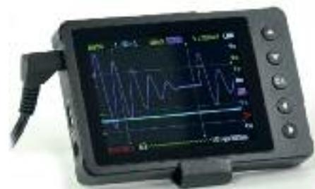
Technische Daten: Farb-LCD 320x240 px, 58 x 44 mm, 0 ... 200 kHz Analogbandbreite, X-Ablenkung: 1  $\mu$ s ... 2 s, Y-Ablenkung: 10 mV ... 10 V, max. Eingangsspannung: 80 Vpp, mehrere Triggermodi, Mess-Marker und Signalanalyse; Signalgenerator 10 Hz ... 1 MHz; USB-Buchse für Verbindung zum PC oder zur Batterieladung, inkl. Messkabel, Schutzhülle und Aufstellbügel; Abmessungen: 91x61x12,5 mm, Masse: ca. 100 g
