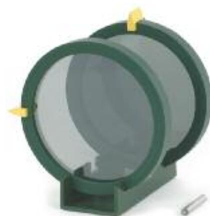
„Spannungsoptische Untersuchungen“; Rahmen pulverbeschichtet grün; U-Profil mit einschraubbarem Gewindestiel zur Montage auf der optischen Bank;
