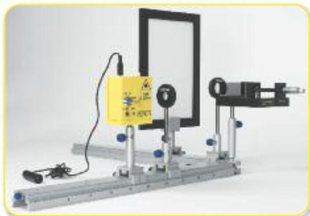
**Versuch:** Messung der Wellenlänge des Laserlichts
