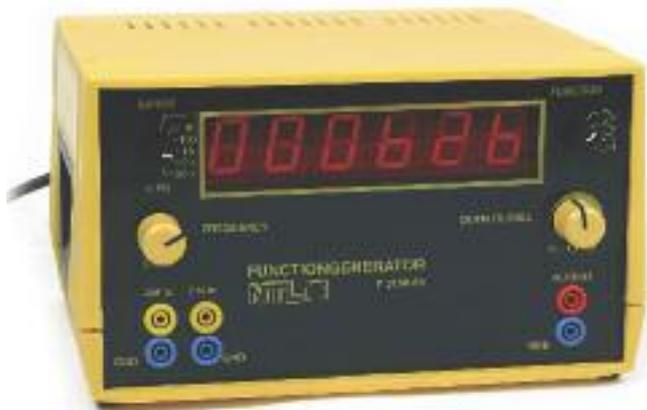
Frequenzanzeige über 6-stellige LED-7 Segment-Anzeige, Höhe= 26 mm, mit 1 Hz-Auflösung;
