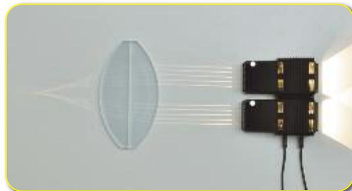
**Versuch:** Lage des Brennpunktes bei einer Bikonvexlinse
