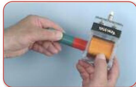
Versuch: Entstehung der Induktionsspannung in einer Spule
