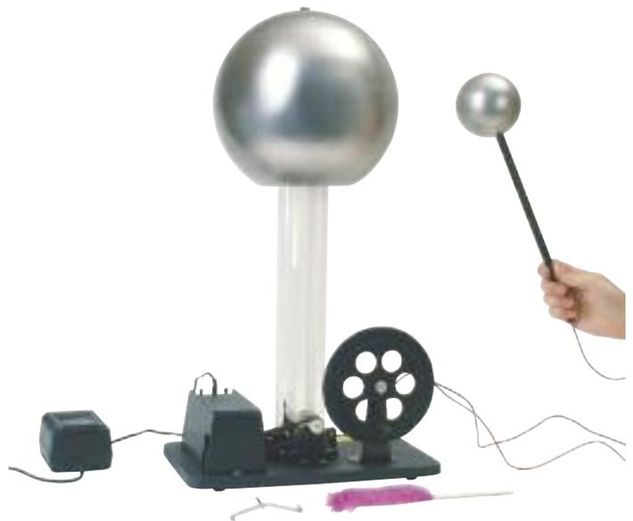
Zur Erzeugung sehr hoher Gleichspannungen für elektrostatische Versuche
