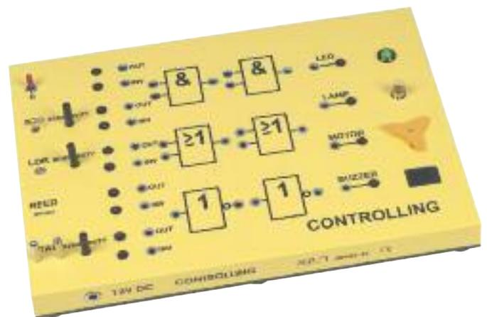
Dieses Panel dient zur Demonstration praktischer Anwendungen der Digitaltechnik bei elektronischen und elektromechanischen Steuerungen, wie z. B. Motorsteuerung, Modell einer Alarmanlage und ähnlicher Schaltungen (Anleitung für 12 Schaltungsbeispiele).
