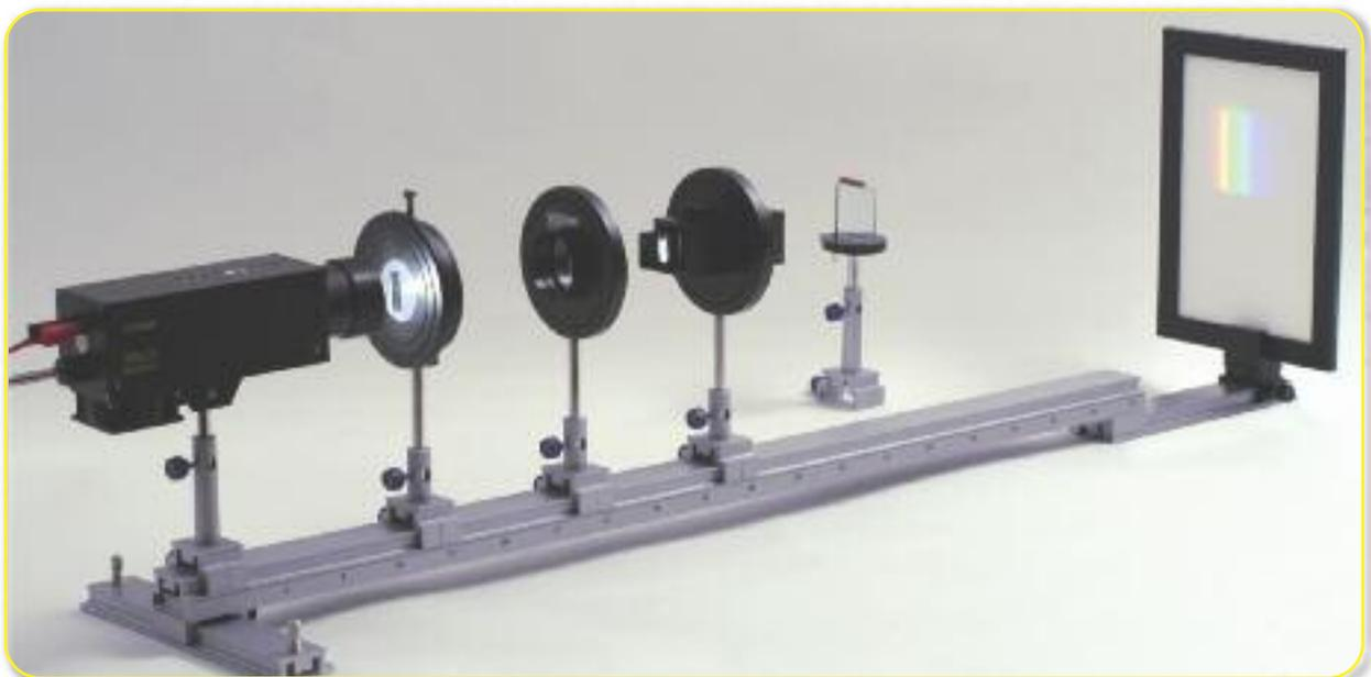
**Versuch:** Zerlegung weißen Lichtes durch ein Geradsichtprisma +
