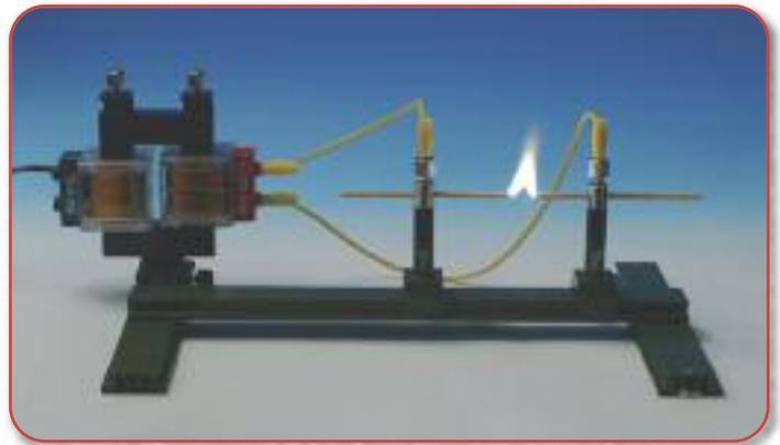
**Versuch:** Modell einer Bogenlampe (Bogenentladung)
