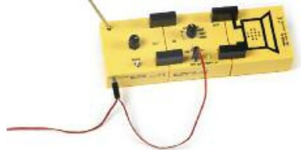
**Versuch:** Mit den Bausteinen FM-Radio MB360-9R, NF-Verstärker MB270-2V und MBC Lautsprecher MB240-1L kann ein UKW-Radio zum Empfang eines UKW-Rundfunksenders aufgebaut werden.
