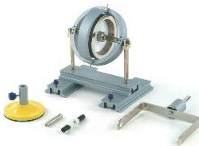
Zur Demonstration der Eigenschaften eines freien Kreisels und auch dessen Präzessionsbewegungen; schwerer zylindrischer Kreisel mit kardanischer Aufhängung, lange Laufzeit durch Achsenlager aus Beryllium-Bronze; Lieferung mit fixer Gabel auf H-Fuß klein mit Nivellierschrauben (zur Lagerung für Antrieb mit Schnur), flexibler Metallgabel mit doppelt kugelgelagerter Stativstange, Rundfuß, Stativstange mit Lagerpfanne und Spitze, Antriebsschnur mit Haltegriff; Kreisel: D=100 mm, Masse: ca. 1400 g
