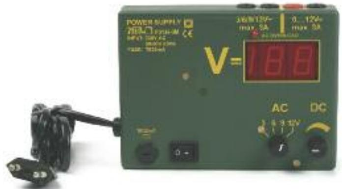
Stufenlos stellbare und stabilisierte Gleichspannung, welche auf einer 20 mm hohen Digitalanzeige abgelesen werden kann sowie fest einstellbare Wechsellspannung; elektronischer Überlastschutz; zur **magnethaftenden** Halterung sind in der Rückwand 10 starke Neodymiummagnete eingesetzt
