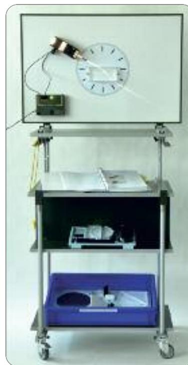
Versuch: Einfallis- und Brechungswinkel im Wasser
