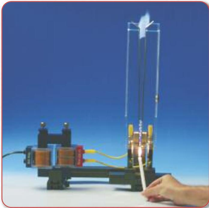
**Versuch:** Aufwärtsbewegung eines Lichtbogens zwischen zwei Elektroden
