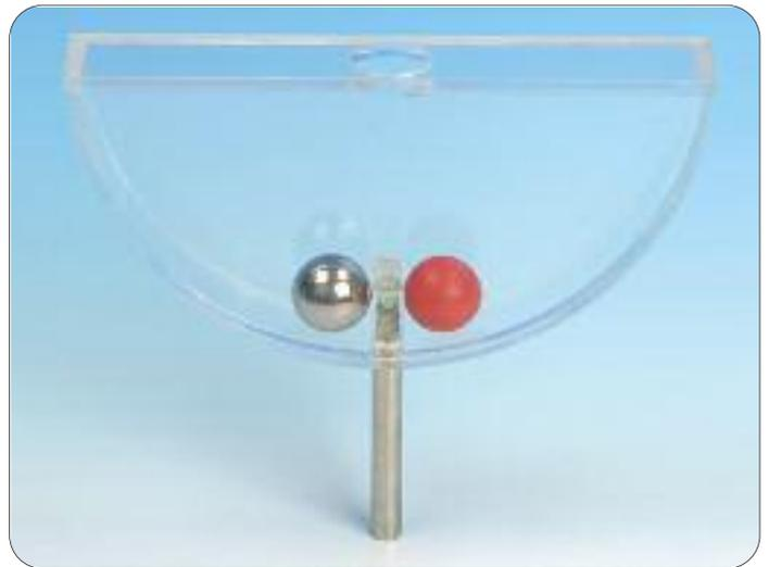
Zur Demonstration der Proportionalität der Zentrifugalkraft zur Masse; halbkreisförmiger Acrylglasshohlkörper (D=200 mm, B=37 mm) auf Stiel (10x70 mm); mit einer Kunststoff- und einer Metallkugel gleichen Durchmessers (D=1")
