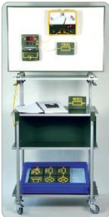
Versuch: Ohm'sches Gesetz - Anwendung
