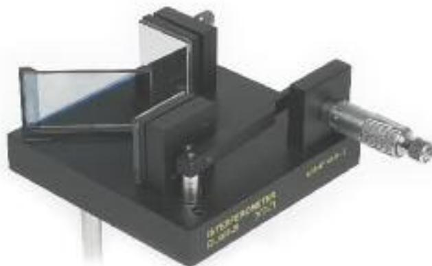
Präzisionsgerät zur Messung z.B. von Lichtwellenlängen, Brechungsindizes usw.
