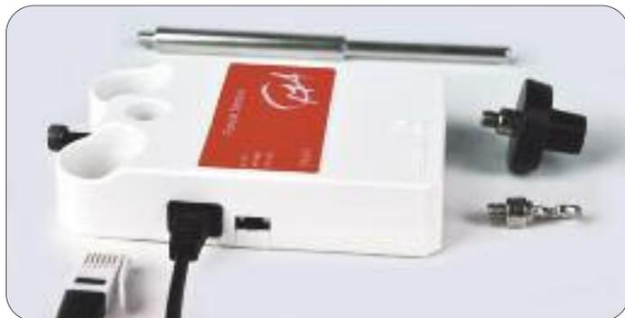
Ein vielseitig anwendbares Gerät um Kräfte zu messen. Es kann sowohl an einer Stativstange als auch auf beweglichen Körpern befestigt werden, um entweder Zug- oder Druckkräfte zu messen. Die Umschaltmöglichkeit zwischen den beiden Messbereichen ermöglicht Kräfte im Bereich von 0,01 bis 50 N zu erfassen.
