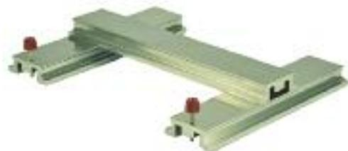
Kompakter, H-förmiger Stativfuß; Alu-Sonderprofil; silbern beschichtet; fix verschraubt mit 2 Nivellierschrauben; Gummifüßchen; stirnseitige Bohrungen zur Befestigungsmöglichkeit auf Tischen mit der Tischklemme Demo; für einen weiteren Aufbau werden Stativreiter benötigt; Standfläche: 260 x 200 mm
