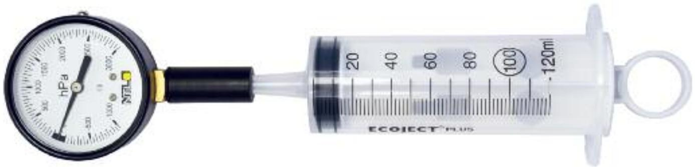
Zur Bestimmung des Zusammenhanges zwischen Druck und Volumen eines Gases bei konstanter Temperatur;
