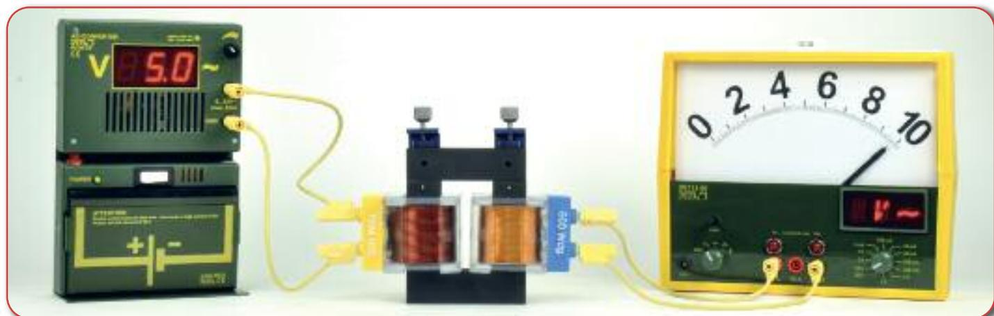
**Versuch:** Unbelasteter Transformator
