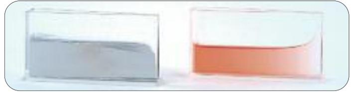
Acrylglasküvette zur Demonstration der Kapillarwirkung und zur Bestimmung der Oberflächenspannung; Keilwinkel: 10°; Abmessungen: 100x55x22 mm
