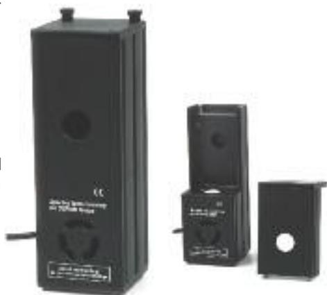
Zum Betrieb der Lampen ist die Spektrallampendrossel DL102-3D erforderlich!
