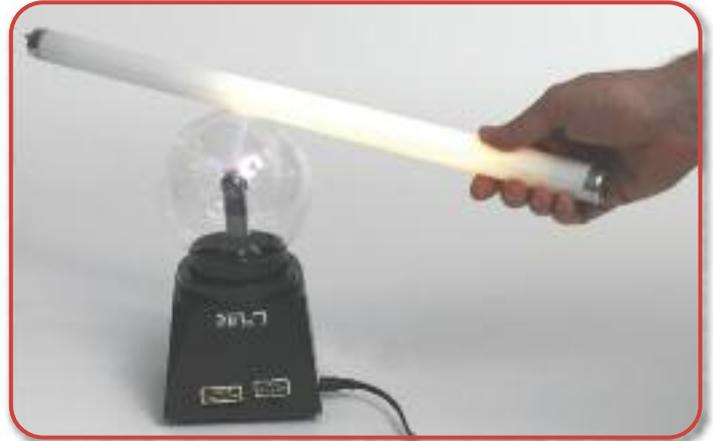
**Versuch:** Nachweis des elektrischen Feldes durch eine Leuchtstoffröhre
