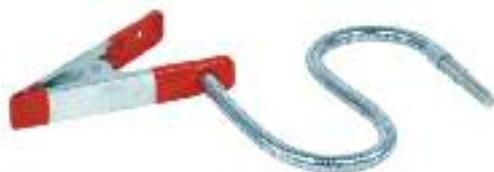
Zur Halterung von Röhren, Stäben oder anderen Kleinteilen in beliebiger Neigung; flexibler „Schwanenhals“ aus Metall; ein Ende mit Stativstange 10 x 40 mm, anderes Ende mit Metallklammer; Haltekraft in Neigung bis ca. 300 g; Metallklammer: Länge= 150 mm, Spannweite= 5 - 40 mm; Gesamtlänge Hals: ca. 530 mm
