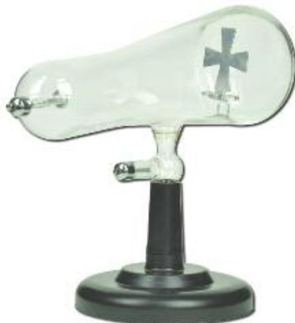
Zum Nachweis der geradlinigen Ausbreitung von Elektronenstrahlen; Vakuum-Glasrohr mit Elektroden und außenliegenden Metallkappen; Metallkreuz; mit Kunststofffuß; Glasrohr: L= 230 mm, D= 80 mm
