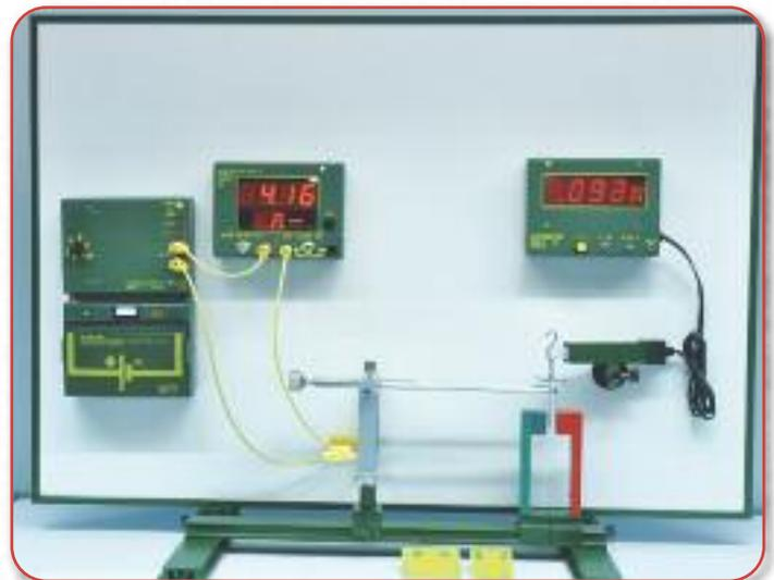
**Versuch:** Stromwaage mit U-Magnet variabel, zur Messung der Lorentzkraft in Abhängigkeit von der Stromstärke, magnetischer Flussdichte und Leiterlänge – Magnettafelauflaufbau
