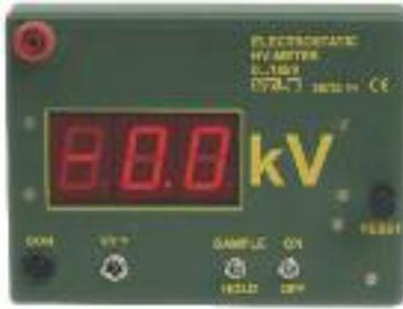
mit dem „Hold“-Schalter wird der gemessene Wert fixiert; Technische Daten:
